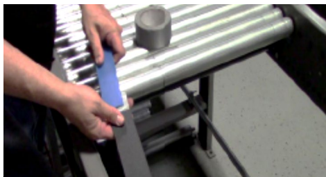
Pegue con cinta los extremos de las correas.
