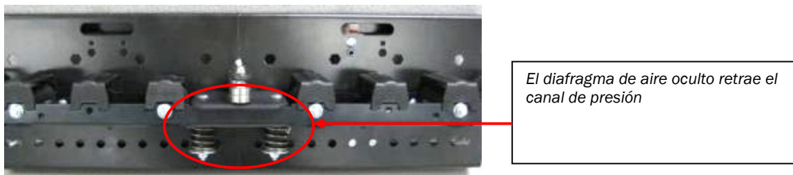
Bandeja de presión NBC: rodillos de resorte a accionamiento, aire para acumular.
