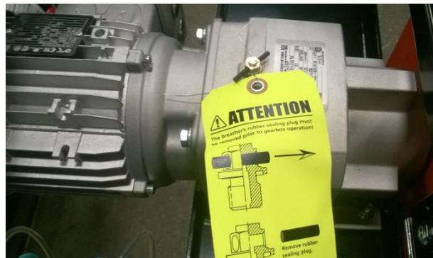
**Nota:** Las etiquetas amarillas pueden quedar ocultas. Inspeccione todos los motores para verificar que tengan ventilación y retire el tapón de sellado, si lo hay, para activarlo.
