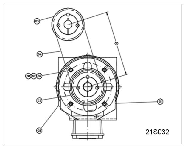
**NOTE:** DRIVE NOT TO EXCEED 500 LBS. OF BELT PULL MAXIMUM SPROCKET SIZE DRIVE: 8MX-53S-36 MAXIMUM SPROCKET SIZE DRIVEN: 8MX-42S-36
