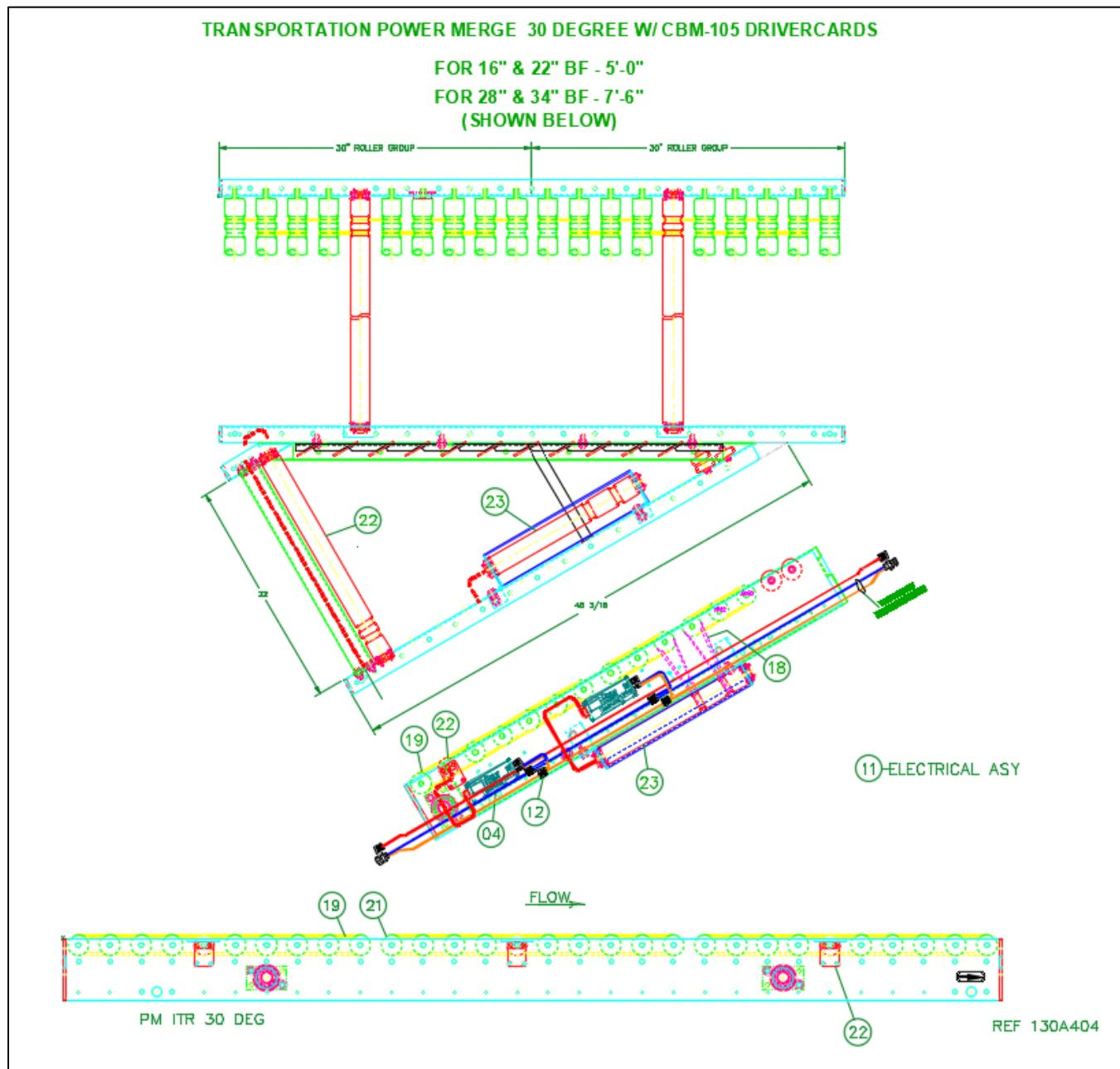
**18.38.1 Piezas de repuesto: Fusión de energía ITR, 3RC, 30 grados**
