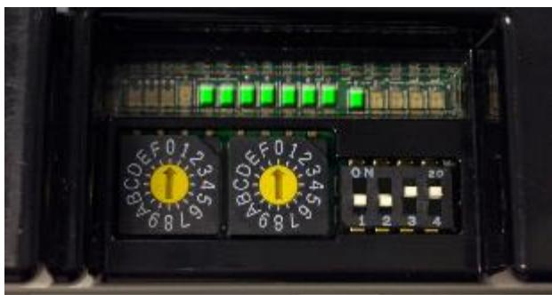
3. Apague el IB-E y ajuste los interruptores giratorios y los interruptores DIP a los ajustes anteriores (u otros operativos).
