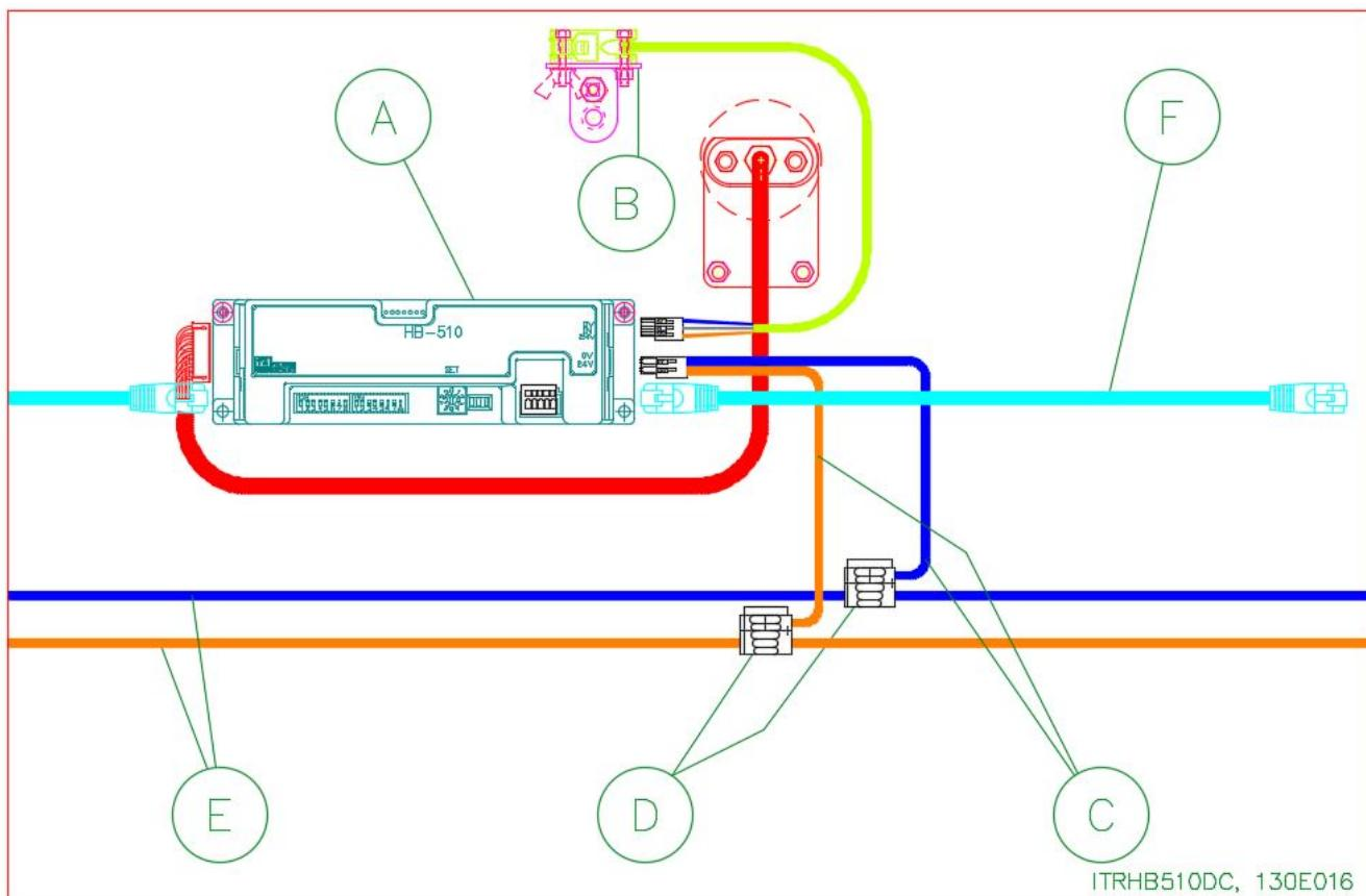
Figura 2: Tarjeta del controlador HB-510
