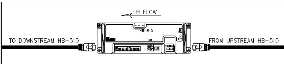
Figura 4: Cable de comunicación de flujo RH HB 510
