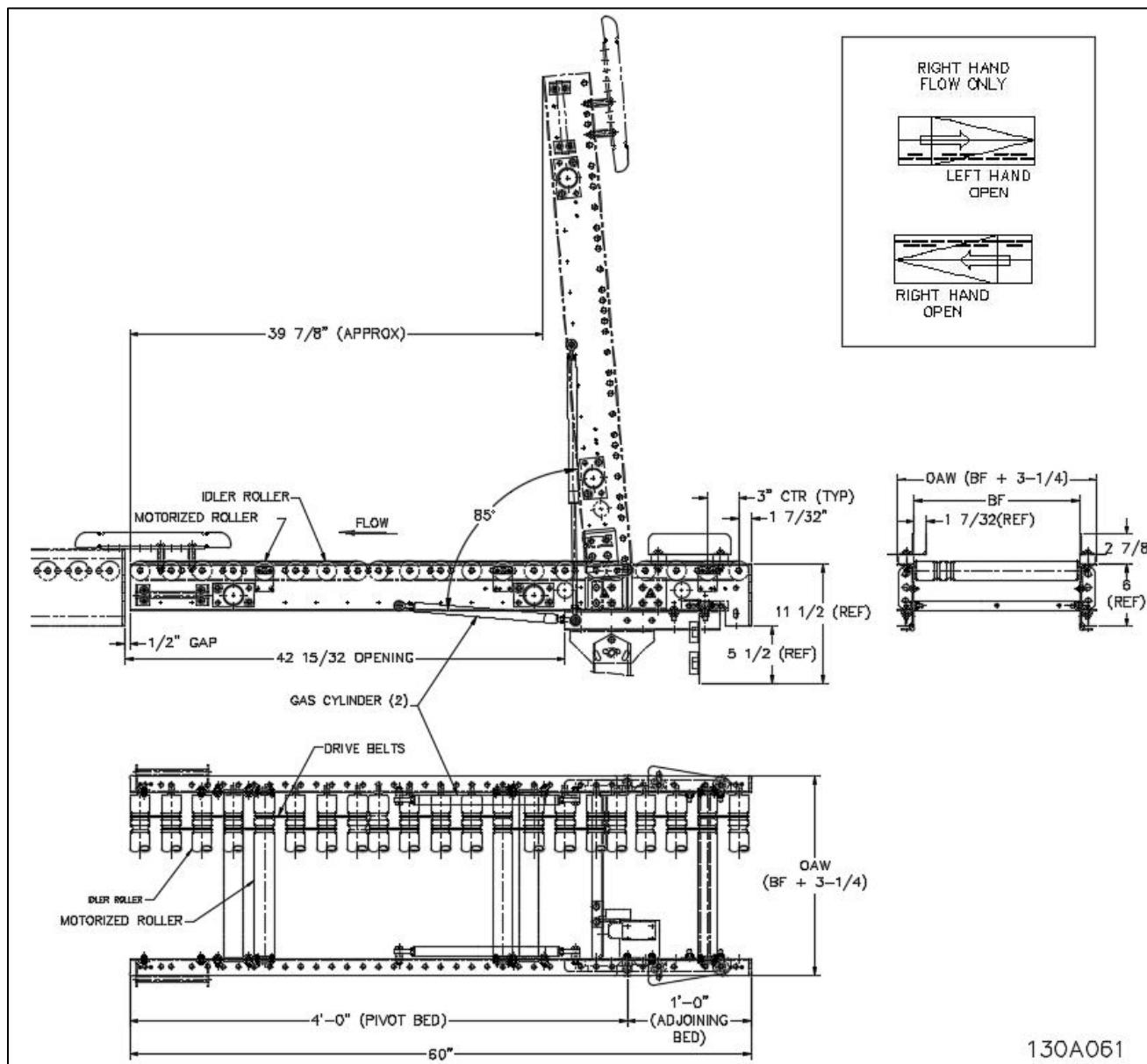
La puerta proporciona un descanso en la línea de la cinta transportadora para el tráfico peatonal. La fuente de alimentación debe ser del lado de carga. La puerta consta de una plataforma pivotante de 1,2 m (4') y una plataforma contigua de 30 cm (1'). Las puertas están disponibles en los elevadores de mano derecha e izquierda.
