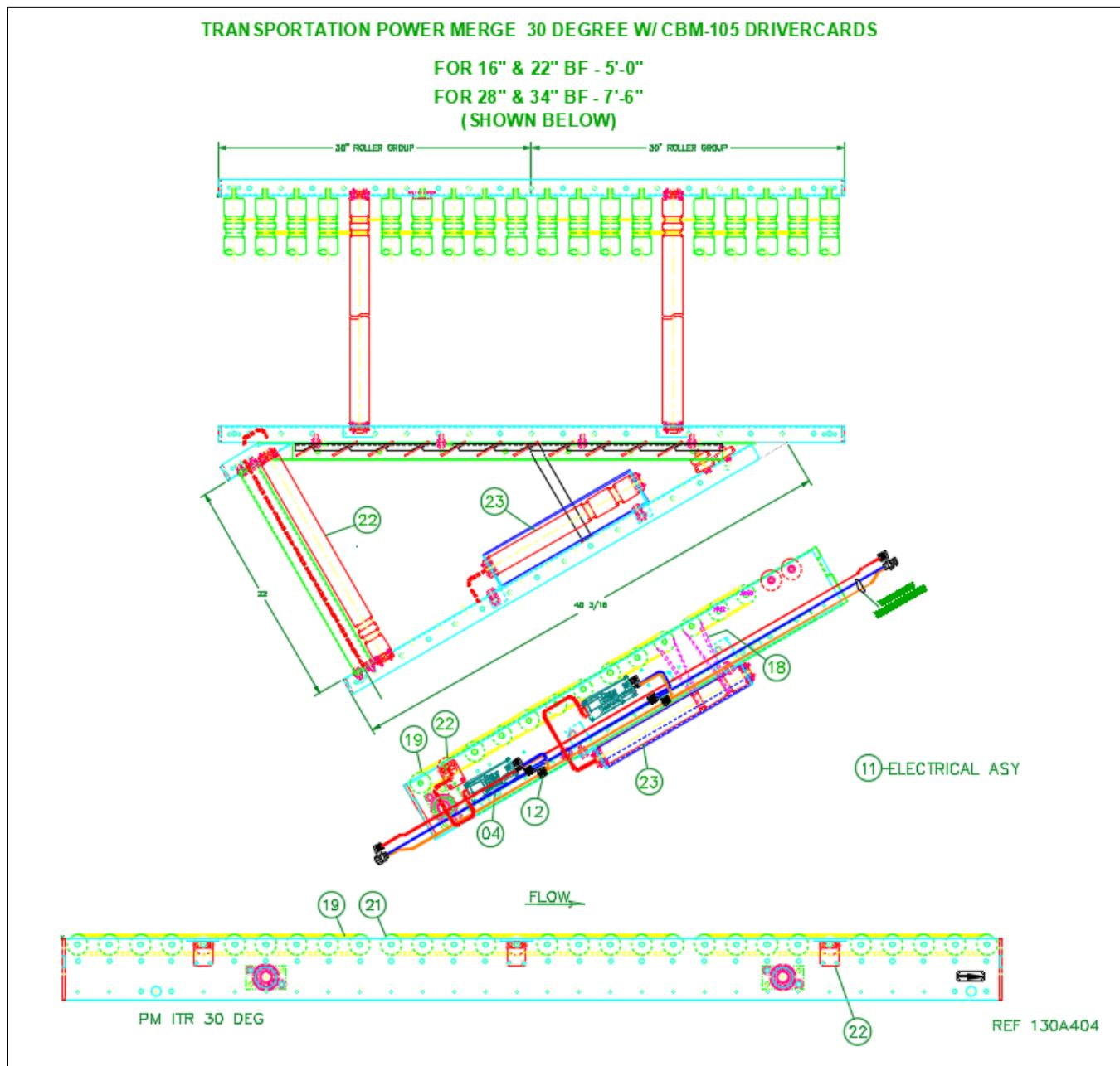
**19.38.1 Piezas de repuesto: Fusión de energía ITR, 3RC, 30 grados**
