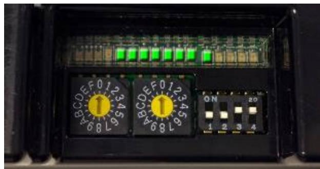
3. Apague el IB-E y ajuste los interruptores giratorios y los interruptores DIP a los ajustes anteriores (u otros operativos).
