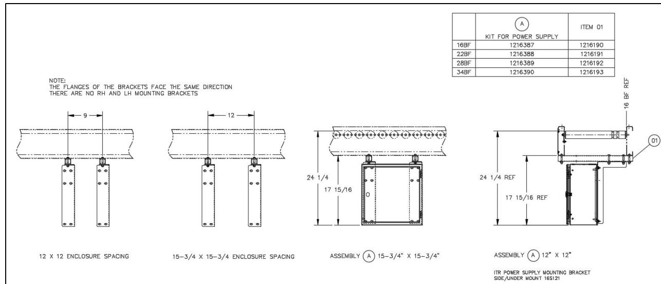
Abrazadera de montaje para ITR STD y CMB, bajo perfil y montaje lateral de 15-3/4" x 15-3/4" & 12"x12"
