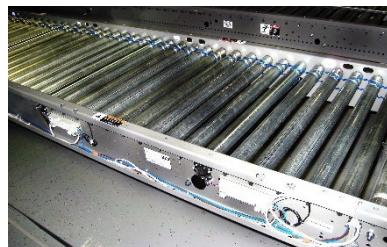
Se añade una etiqueta de identificación al exterior del canal de un lado o en un travesaño, cerca de un extremo de cada plataforma de la cinta transportadora.
