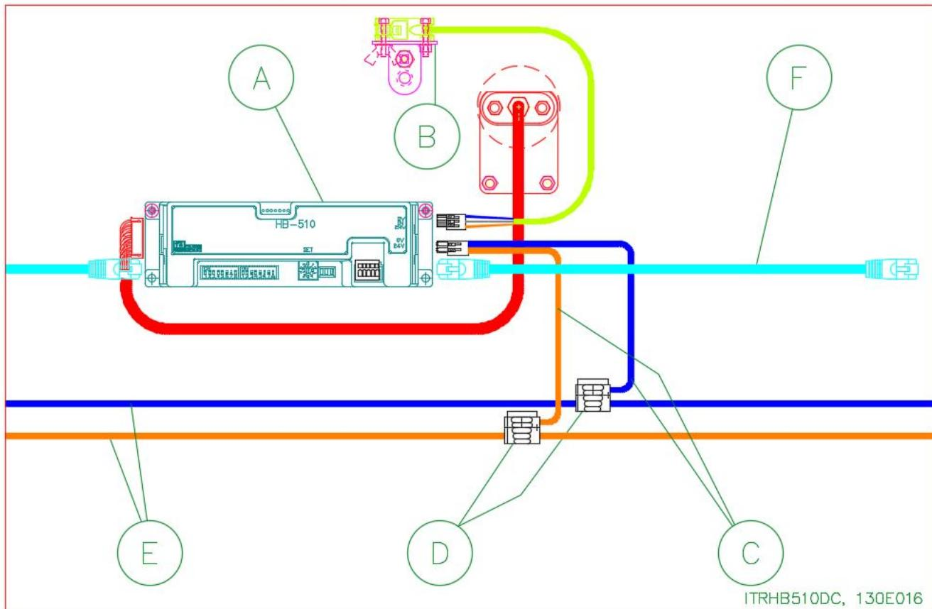
Figura 2: Tarjeta del controlador HB-510
